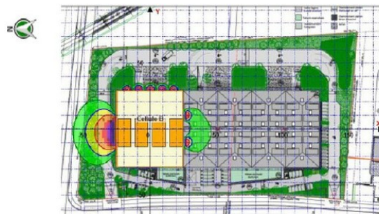
Modélisation des effets thermiques de chaque cellule (Flumilog)
