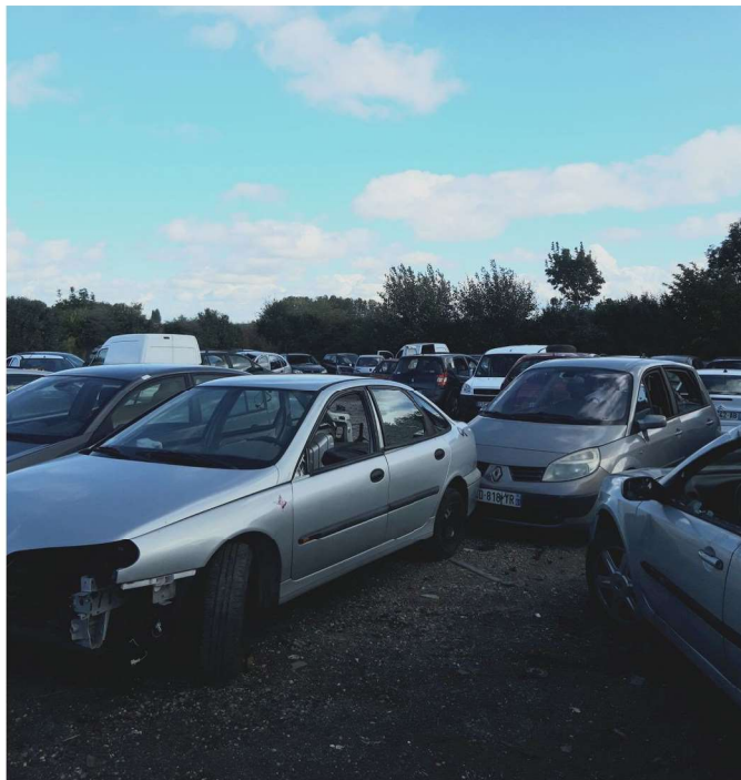
Photo 1 prise le 04 octobre 2021 : Véhicules en attente de dépollution située sur une aire non imperméabilisée et non munie de rétention.
