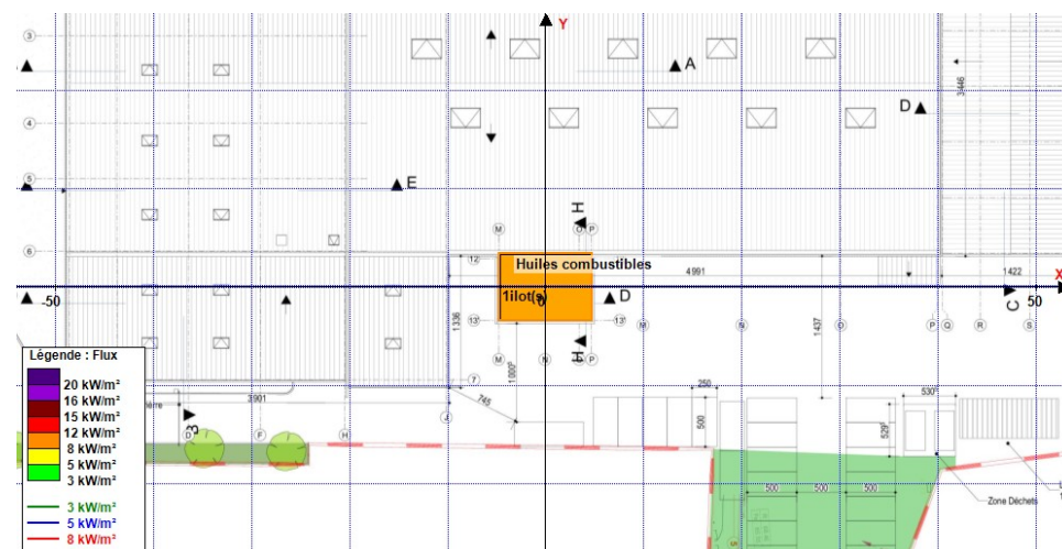
Figure 3. Étude des flux thermiques au niveau du local Huiles avec une palette type 1510 (source PAC mis à jour déposé le 06 février 2025) :
