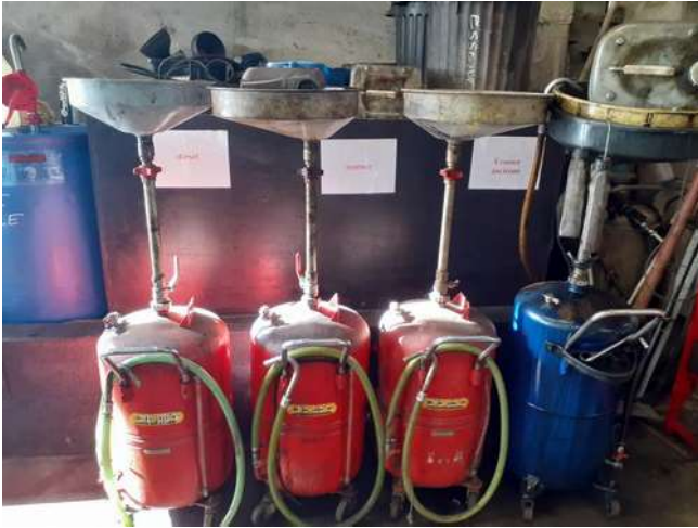
Dispositifs de récupération des fluides lors des étapes de dépollution vidés après chaque utilisation
