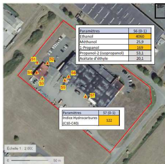
Figure 2 : Cartographie des anomalies mesurées dans les sols au cours des investigations réalisées en août 2021 (sur fond de vue aérienne de Géoportail – Source : Rapport Bureau Veritas 0797715/11318913-1 Ind 1 du 01/09/2021)
