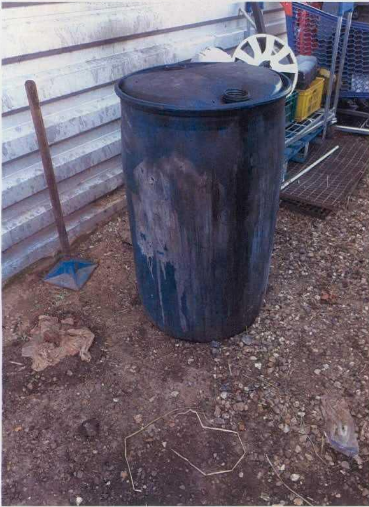
Stockage d'huile usagée sans rétention
