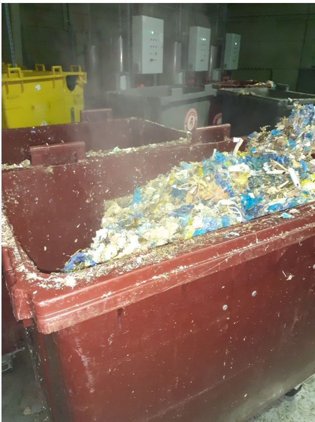
Broyats issus de l'ECODAS T2000 avec vapeurs odorantes très fortes
