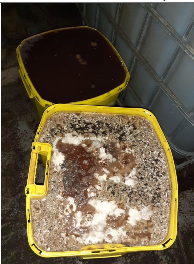
Effluents liquides correspondant aux rejets de la phase régénération, collectés dans des bacs en plastique qui débordent
