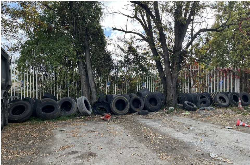
Annexe 10 : Pneus usagés stockés le long des abords du site, présentant un risque de propagation d'un incendie à l'extérieur
