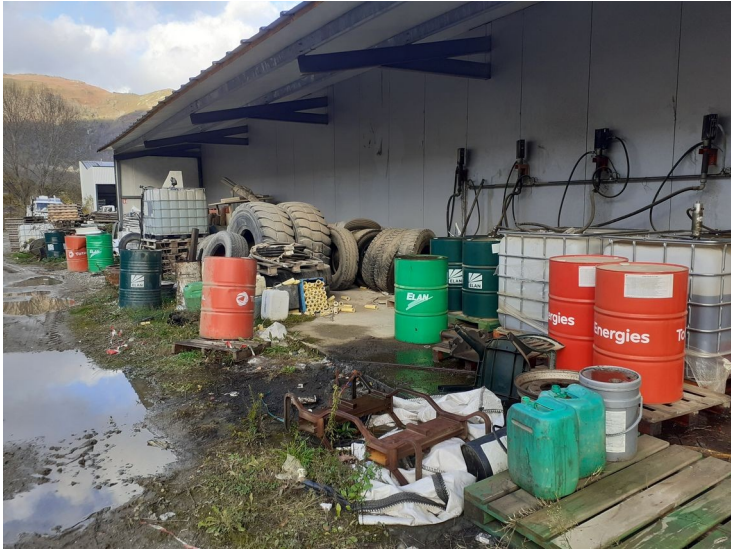
Photo 13 : entreposage de bidons d'huile en dehors de rétention
