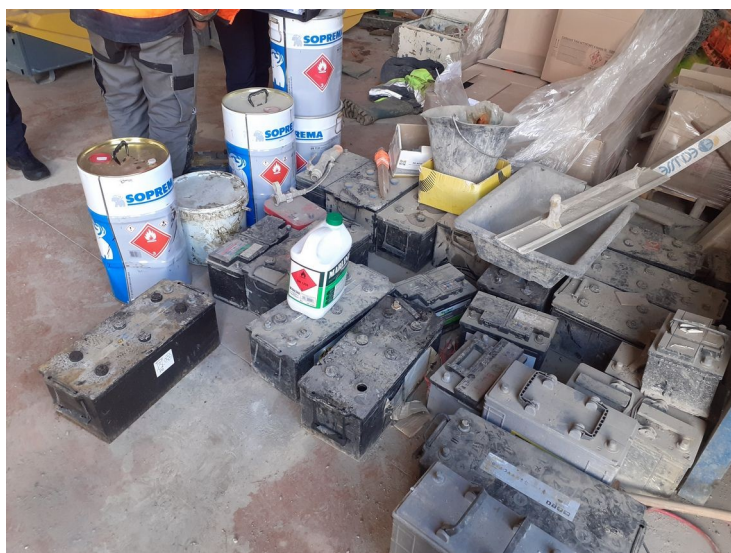
Photo 12 : entreposage de liquides inflammables à proximité de batteries usagées
