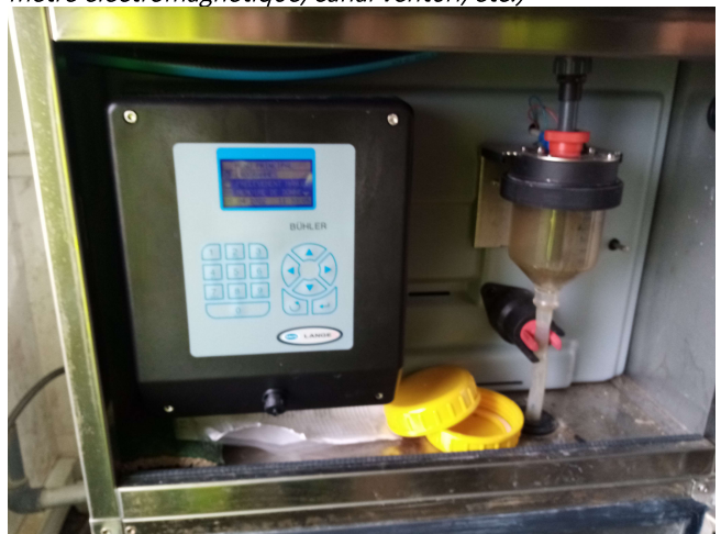
Illustration n°4: chaîne de mesures à la STEP Fonderie (débitmètre électromagnétique, canal venturi, etc.)
