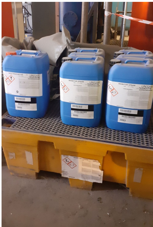
Stockage de produits incompatibles (spectrus NX1100 et Inhibitor OP8456) sur rétention commune
