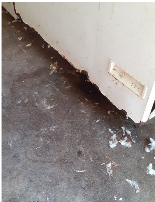
Bas de congélateur rongé par la rouille avec trace d'écoulement
