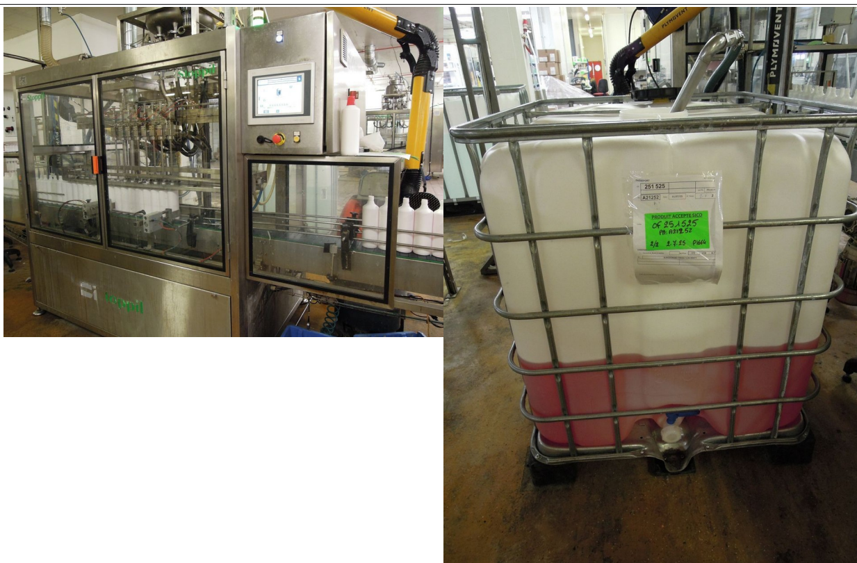
Lignes de conditionnement et d'étiquetage en vrac des détergents – isoconteneur de détergent en amont de ligne
