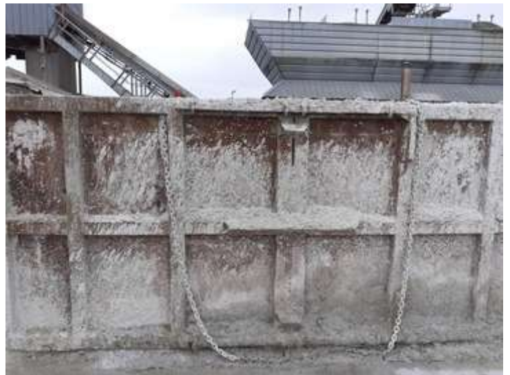
Benne de récupération des décantats des bassin de décantation en attente de transfert en ISDI
