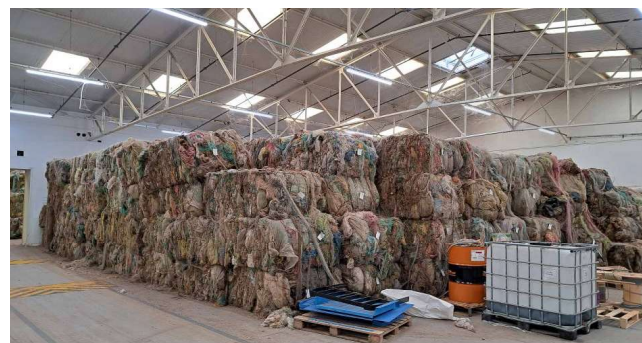
Photo 4 : Entrposage de produit chimiques sans rétention.
