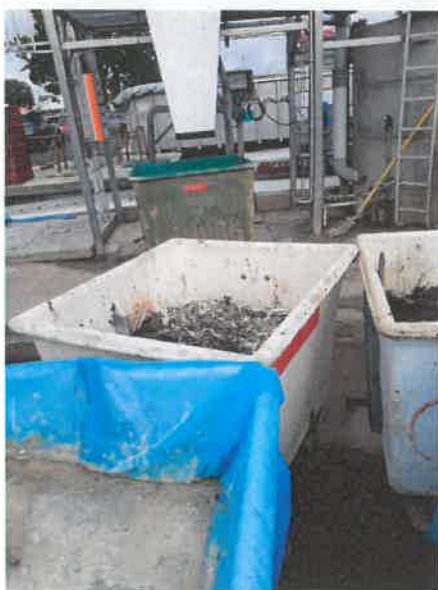
Bacs de stockage des déchets (graisse dégrillage, plumes ...) percés
