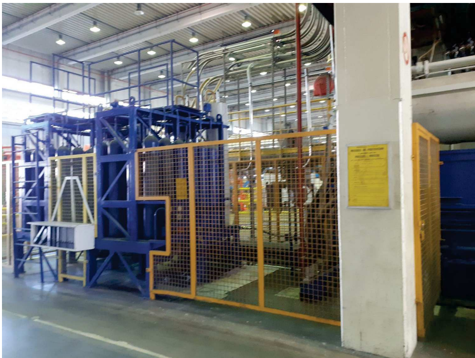
2/ batterie d'accumulateurs de la presse KM5400
