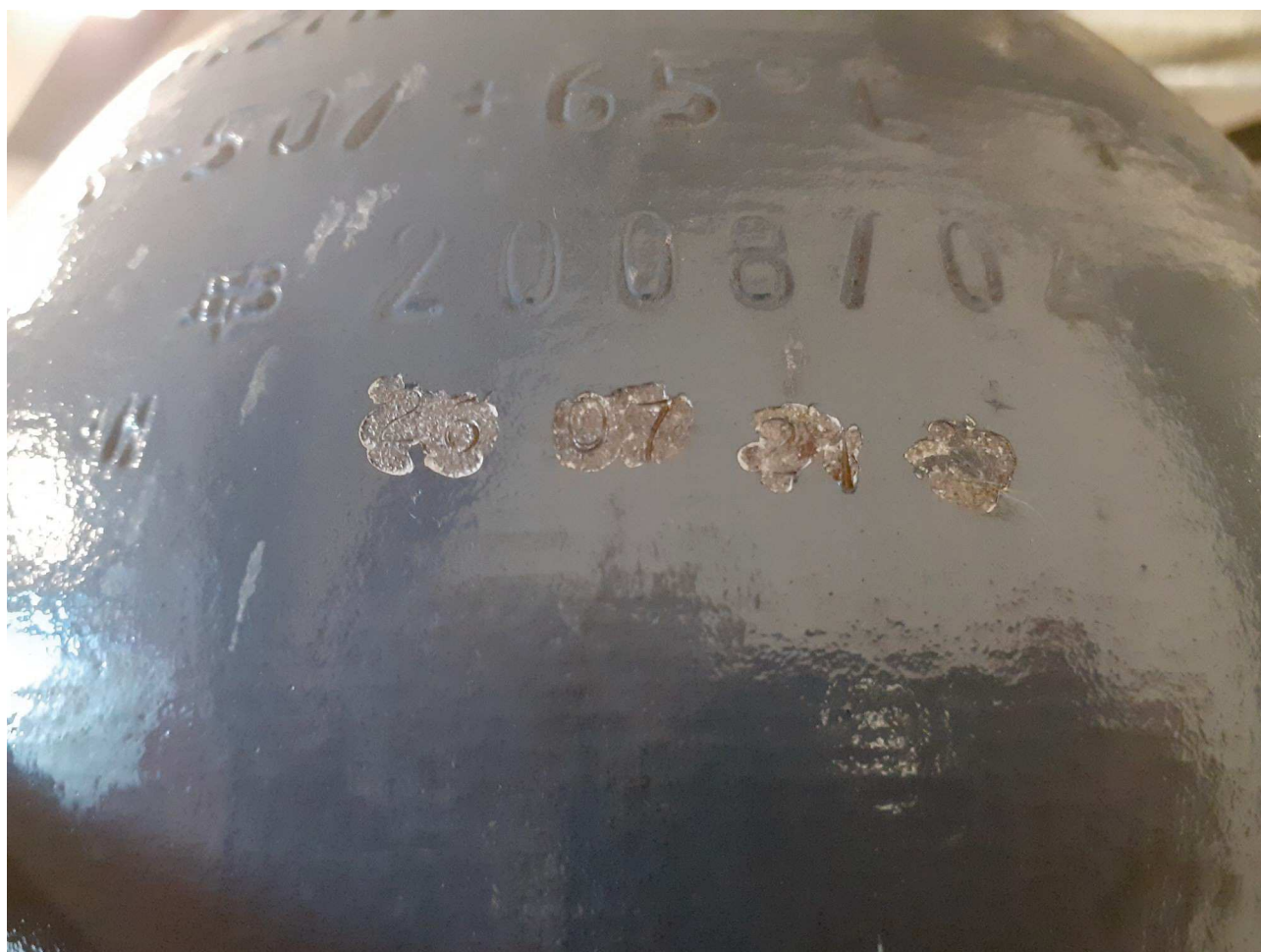
6/ accumulateur 8410131 – marquage dernière épreuve hydraulique 26/07/21
