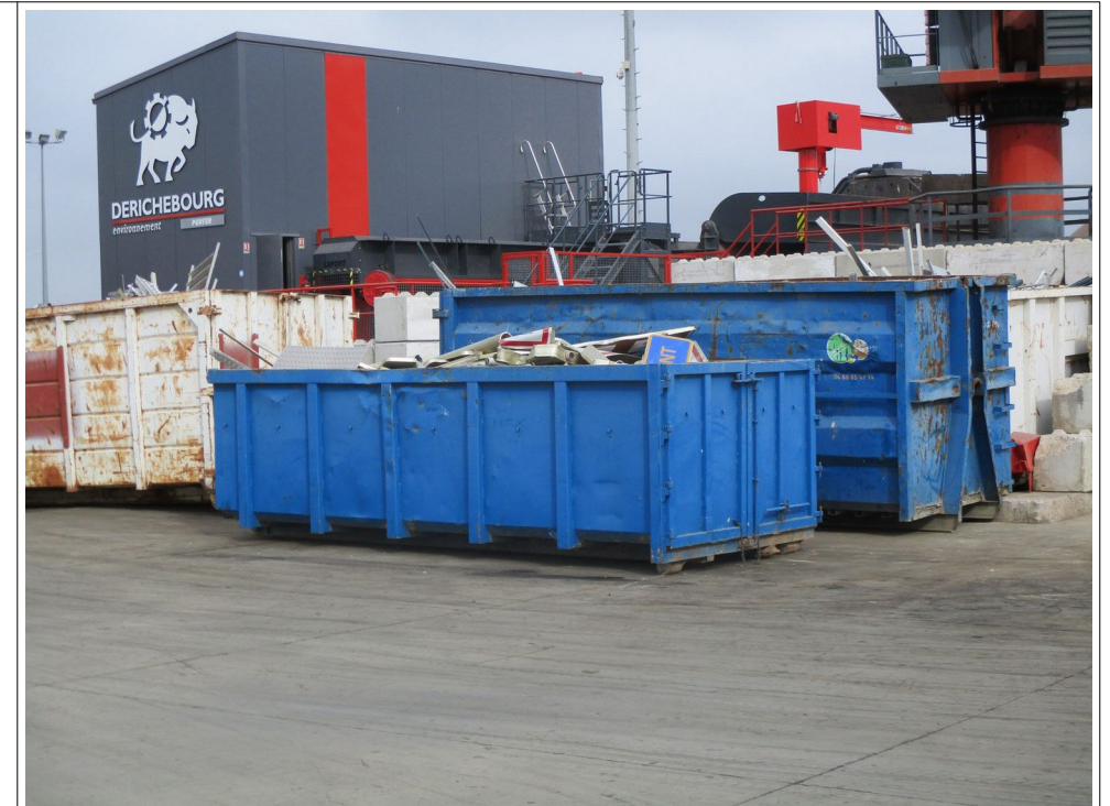
Bennes de stockage des aluminiums nécessitant la réalisation d'un cisailage avec, en arrière plan, le bâtiment calfeutré renfermant le groupe hydraulique de la nouvelle presse cisaille
