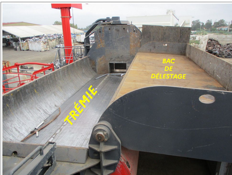
Bac de délestage installé le long de la trémie de la nouvelle presse cisaille
