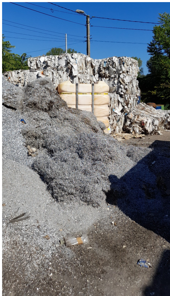
Figure 4: Tournures d'aluminium non stockées à l'intérieur d'un bâtiment
