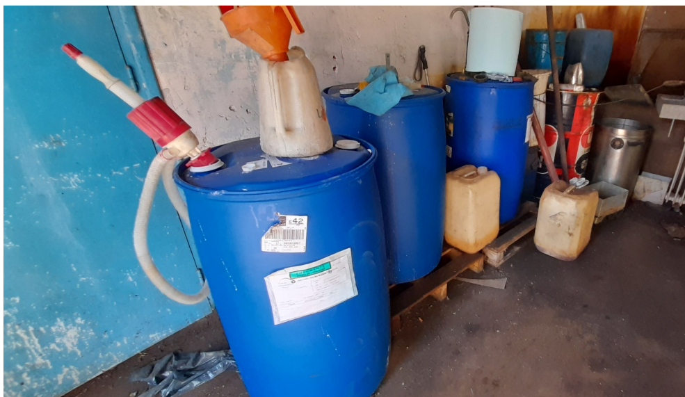
Figure 1: fûts non disposés sur rétention
