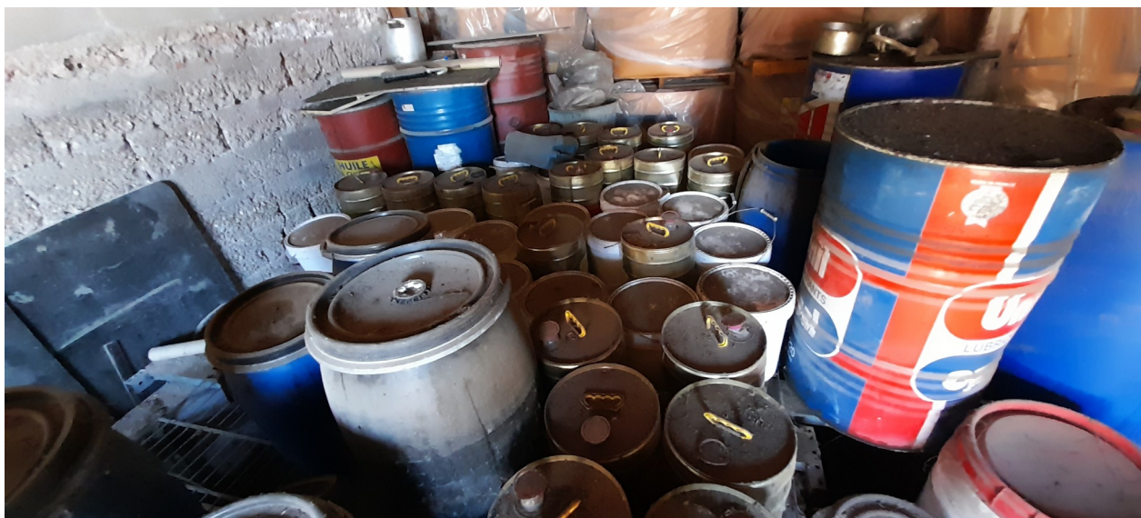
Figure 2: 50 à 60 fûts non étiquetés et en partie seulement sur rétention (1)
