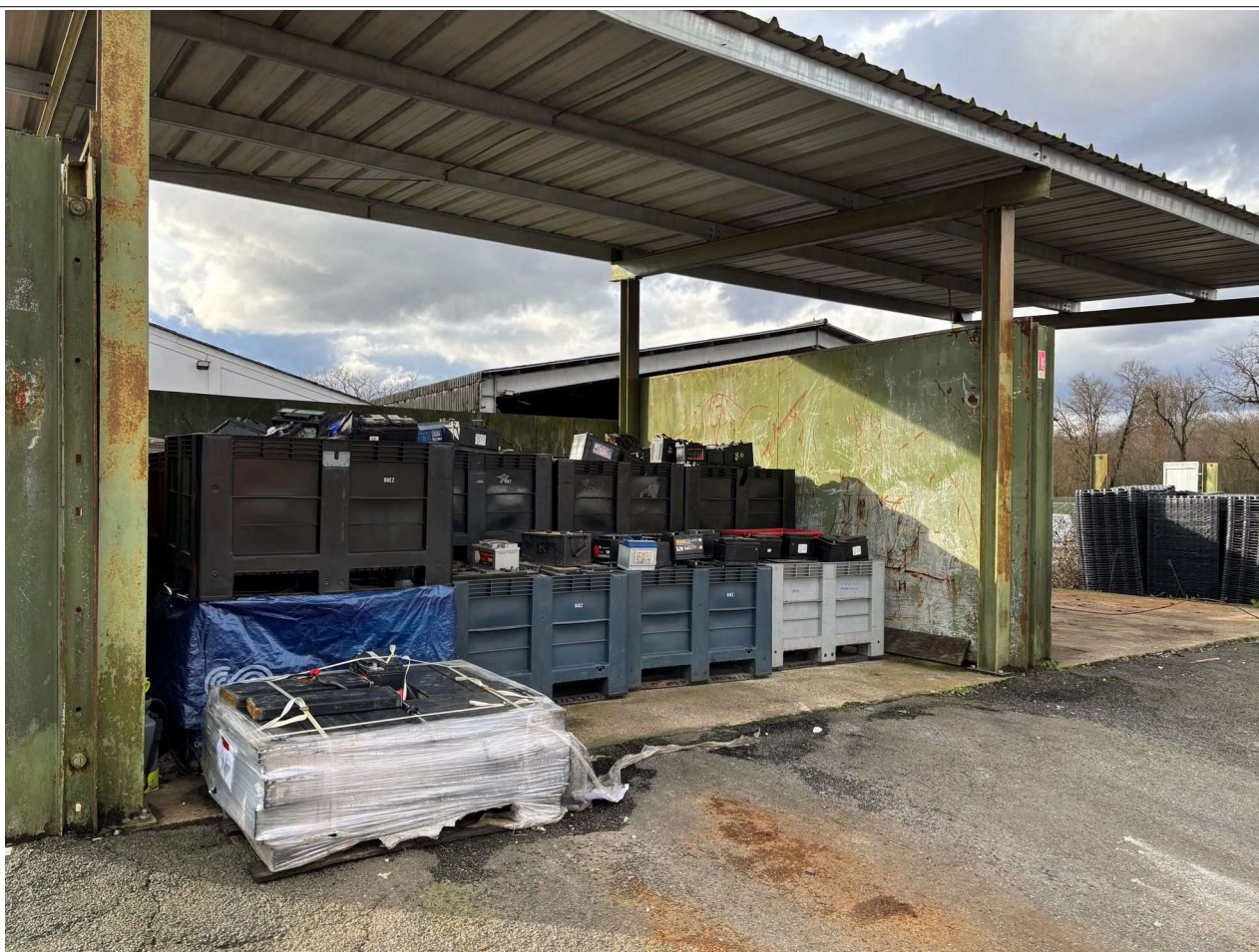
Entreposage des batteries sur site dans des conditions non-conformes
