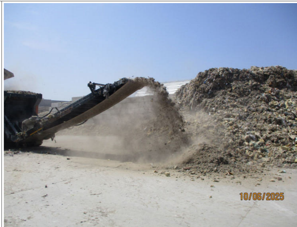
Opération de broyage de déchets non dangereux de produits rembourrés
