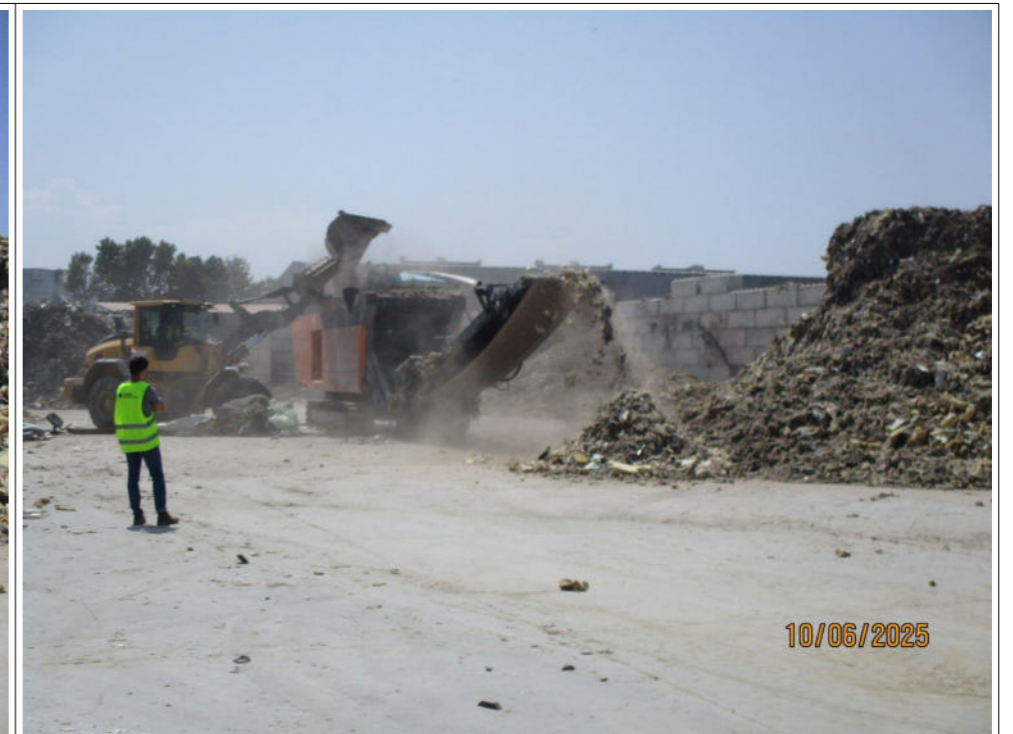
Opération de broyage de déchets non dangereux de produits rembourrés
