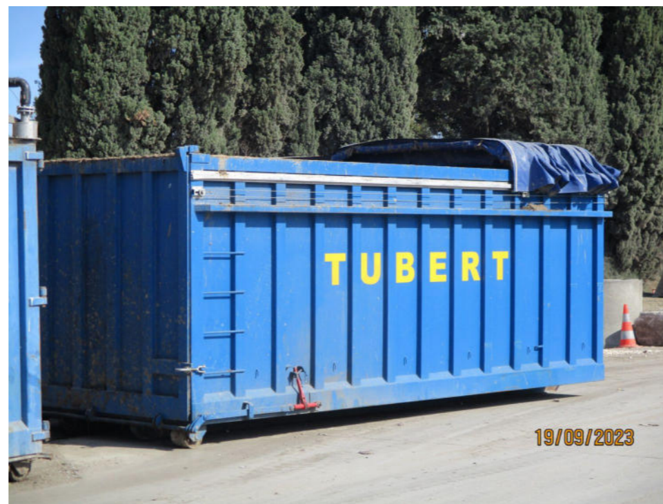
Benne (celle, ci à gauche) d'entreposage des emballages encore humides extraits des biodéchets, munie d'une bâche rétractable manuellement.
