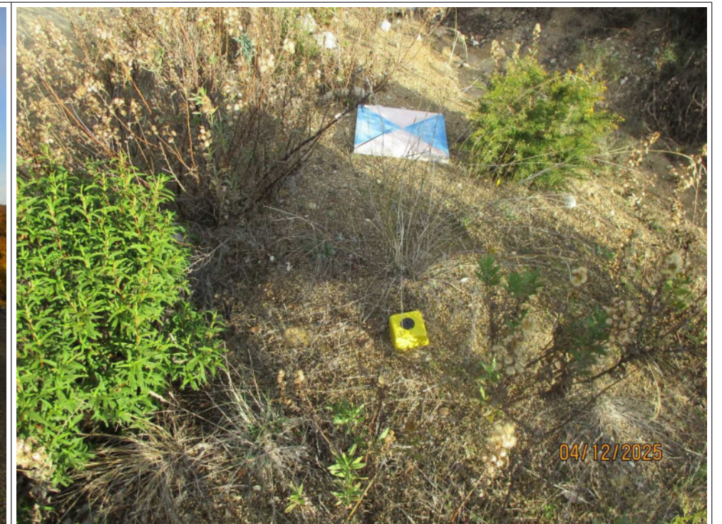
Borne géo-référencée située juste derrière le portail fermant le portail d'accès à la piste menant à la carrière et cible pour le drone
