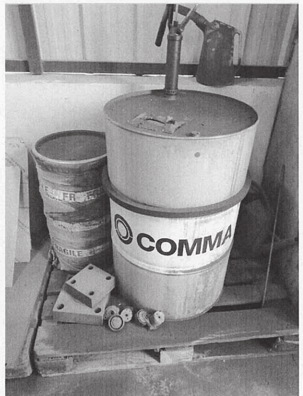
Bidon hydrocarbures sans rétention
