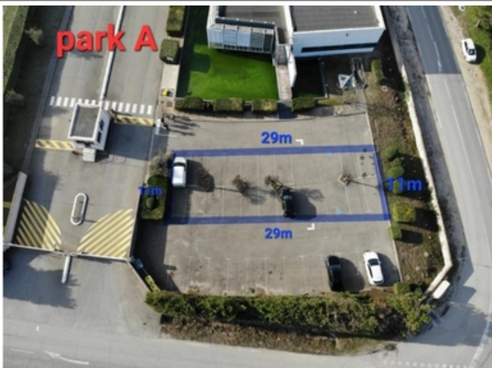
Vue aérienne du parking A avec les dimensions de la zone d'implantation – Puissance de crête installée : 65 kW
