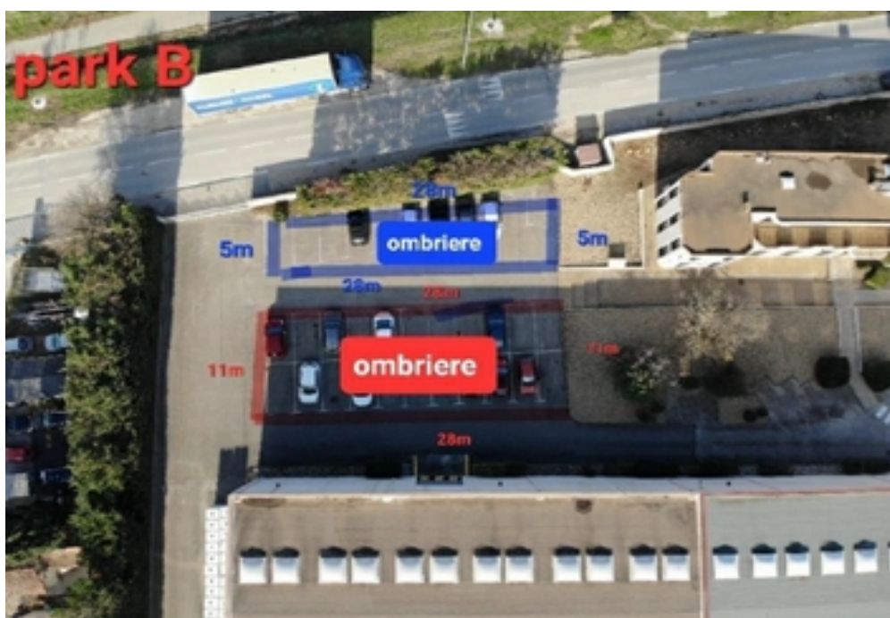
Vue aérienne du parking B avec les dimensions des zones d'implantation – Puissance de crête installée : 26,73 kWc + 77,76 kWc = 104,49 kWc
