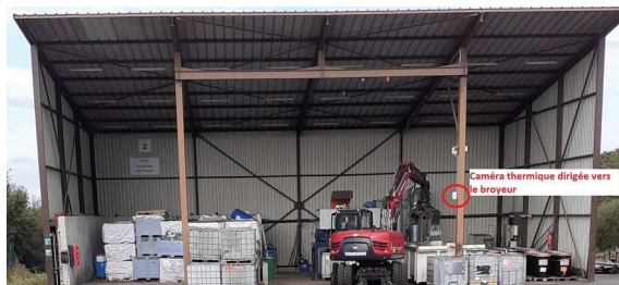
broyeur sous auvent avec caméra thermique
