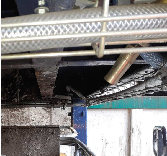
broyeur :buses d'extinction automatique
