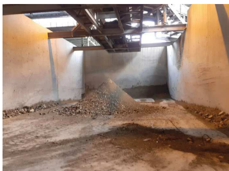
Case récupérant les mâchefers refroidis
