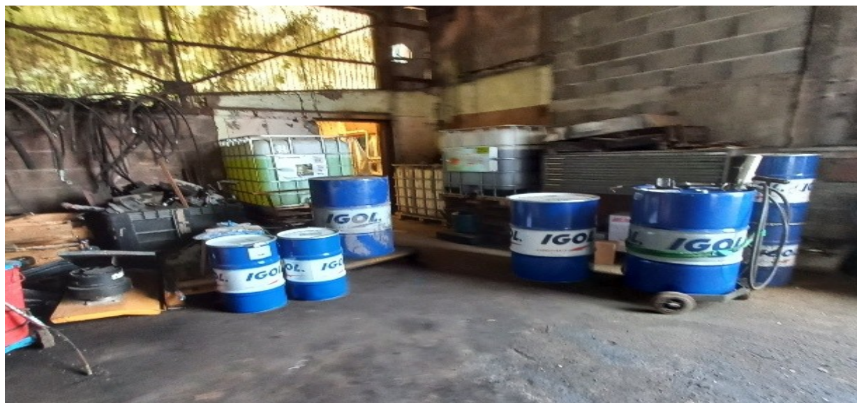
Figure 2: Cuves sur un empilement de palettes, hors rétention et fûts de produits chimiques pâteux
