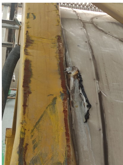
Citerne dégradée avant l'incendie (selon l'exploitant)
