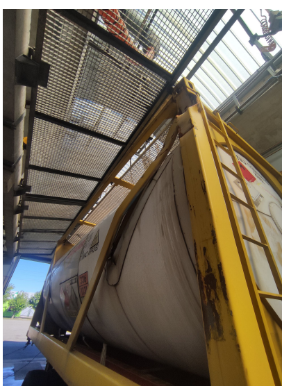
Citerne dégradée avant l'incendie (selon l'exploitant)
