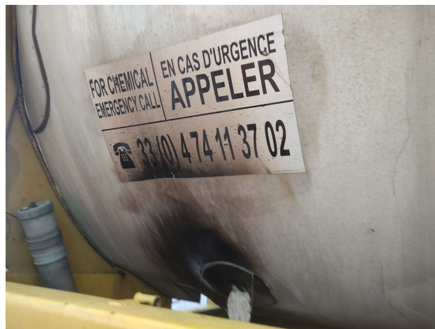
Orifice de par lequel l'incendie se serait propagé à l'intérieur de la citerne
