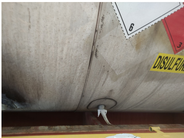
Chiffons placés dans les orifices de la citerne à son arrivée sur site (selon l'exploitant)
