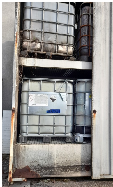
Constat n°7 : Prévention des pollutions accidentelles Armoire de stockage des containers de déchets dangereux pleins
