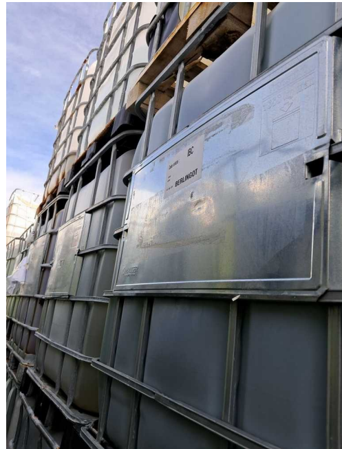
GRV avec l'étiquette d'un autre produit que celui contenu et sans pictogramme et mentions de dangers
