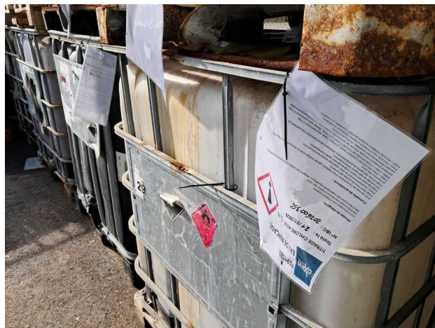
GRV avec étiquetage double non-conforme
