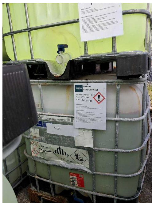
GRV avec double étiquetage non-conforme
