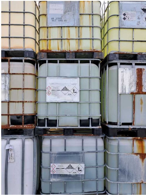
GRV avec l'étiquette d'un autre produit que celui contenu
