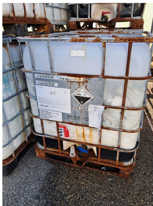
GRV sans bouchon obturateur de pied
