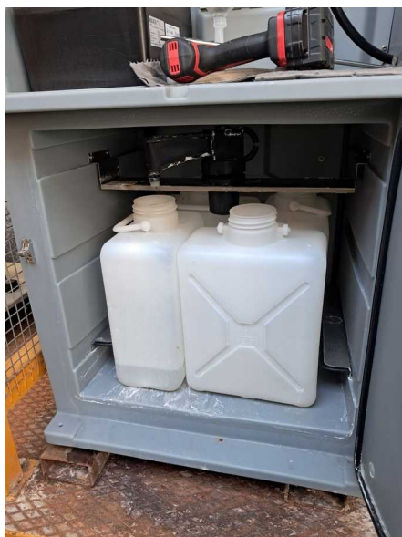
Enceinte réfrigérée pour prélèvement SRR1
