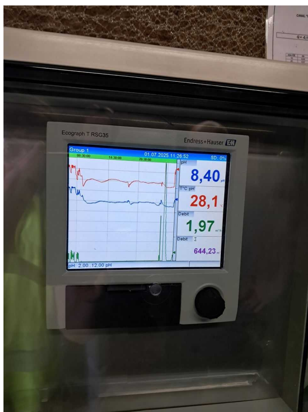
Écran débitmètre-pHmètre-température SRR2
