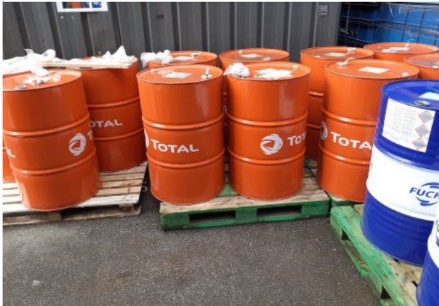
Fûts de produits chimiques partiellement remplis en extérieur et sans rétention
