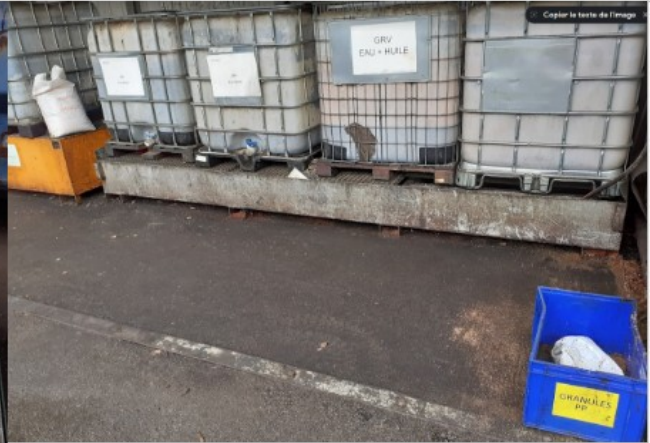
Contenants qui ne sont pas systématiquement identifiés et présence d'un absorbant humide et quasi vide sans moyen de l'utiliser (pelle...).
