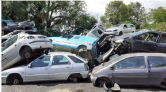
Véhicules partiellement non-dépollués empilés de façon dangereuse sur une hauteur supérieure à 3m
