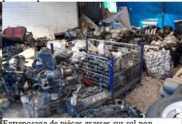
Entreposage de pièces grasses sur sol non imperméabilisé et sans emballage étanche
