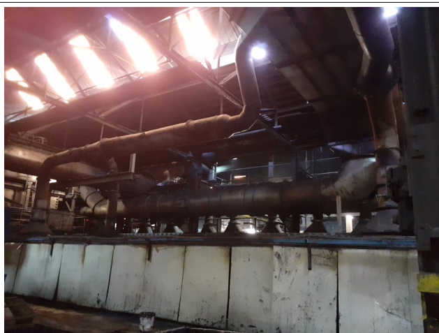
Ligne de refroidissement des moules après coulée
