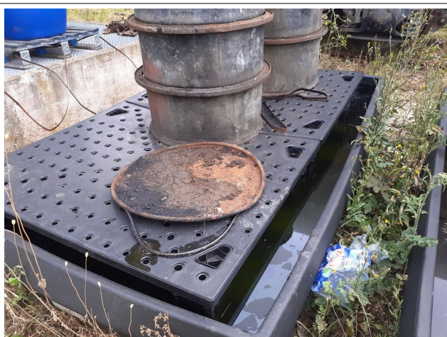
Fûts brûlés sur rétentions presque pleines et non protégées des eaux pluviales
