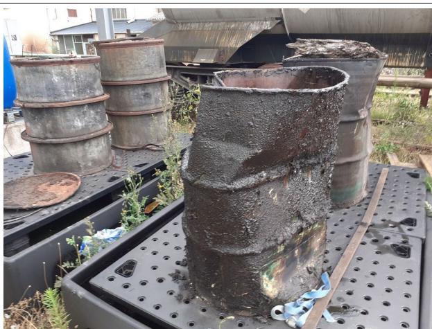
Fûts brûlés sur rétentions presque pleines et non protégées des eaux pluviales
