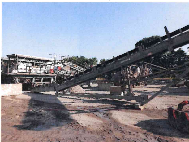
Installation temporaire de broyage, concassage, déferrailage de mâchefers
