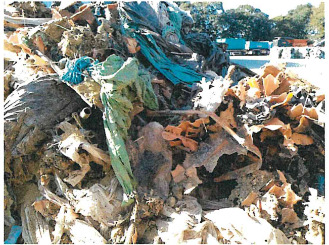
Photo 2 : tas de déchets résiduels suite à l'incendie. Mélange constitué au cours des opérations d'extinctions de broyats de plastiques durs (en partie droite) et de plastiques souples issus des stocks voisins (en partie gauche)
