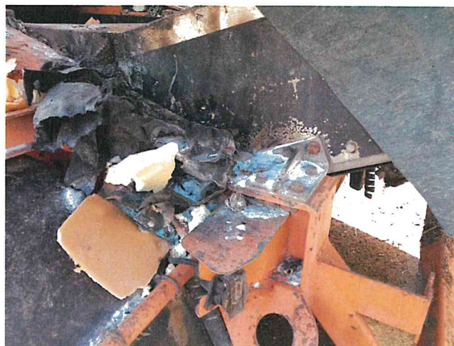
Photo 10 : broyats de plastiques durs, en partie fondus, retrouvés sur le broyeur après l'incendie.
