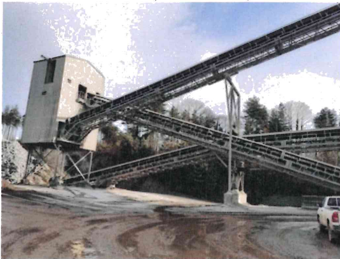
Installation de convoyage et de broyage/concassage de produits minéraux
