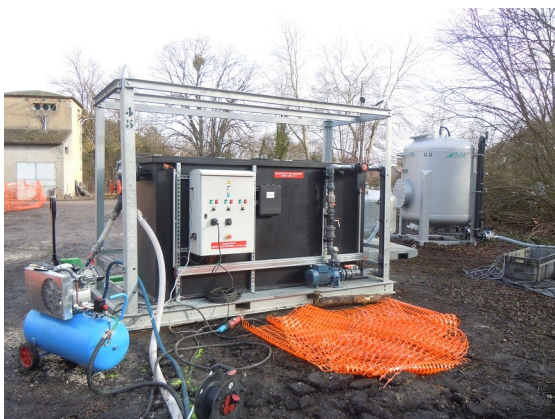
Station de traitement des eaux pompées
