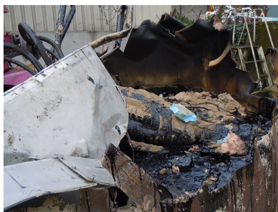
Fond de la cuve de 75 m 3 (présence d'hydrocarbures pâteux sur une hauteur de l'ordre de 40 cm)
