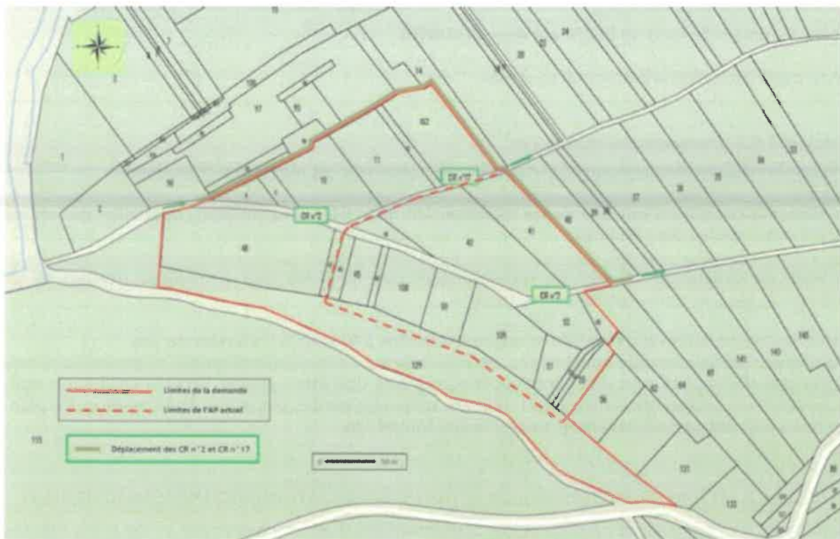
Figure 18 : Déplacement des chemins ruraux n° 2 et 17
