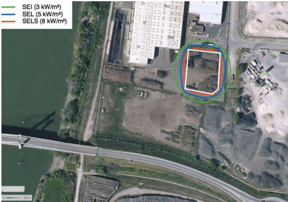
Figure 3-12 : Incendie de la zone de réception/stockage des déchets verts – Zones d'effets thermiques
