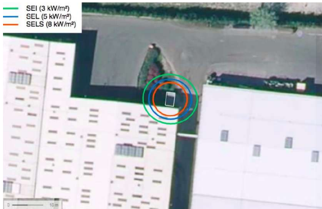
Figure 3-7 : Incendie du stockage de GNR – Zones d'effets thermiques
