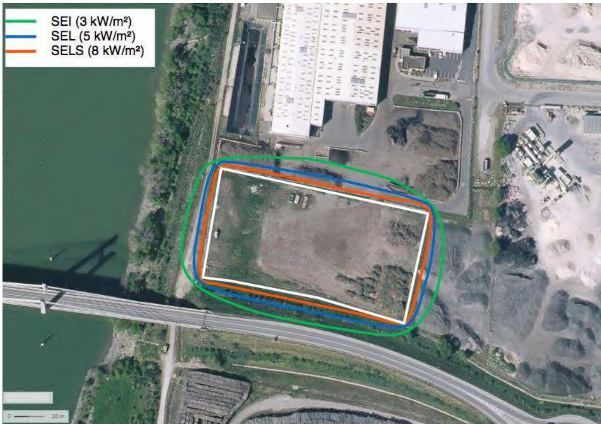
Figure 3-10 : Incendie de la zone de stockage/broyage de déchets verts – Zones d'effets thermiques
