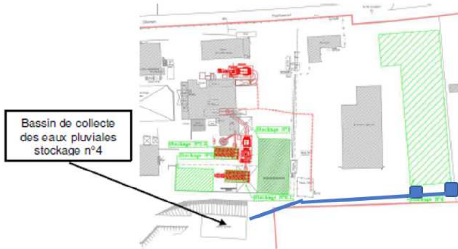
Figure 7: Réseau et bassin de collecte des eaux du stockage 4
