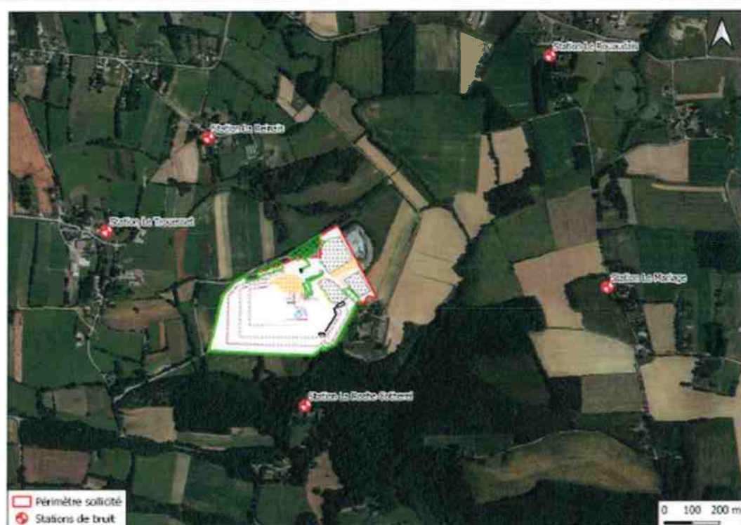
Stations futures de contrôle des niveaux sonores
