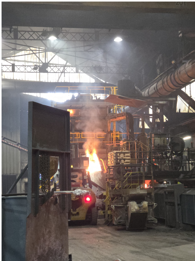
Illustration des émissions diffuses non captées de la poche mobile de fonte liquide à côté de la hotte de décrassage
