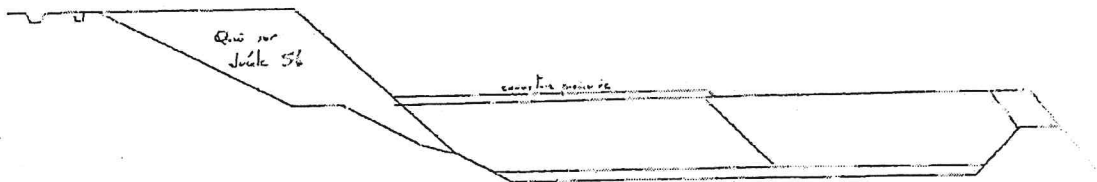
Couverture provisoire sur la 1 ère moitié et exploitation de la 2 ème à hauteur de la risberme
