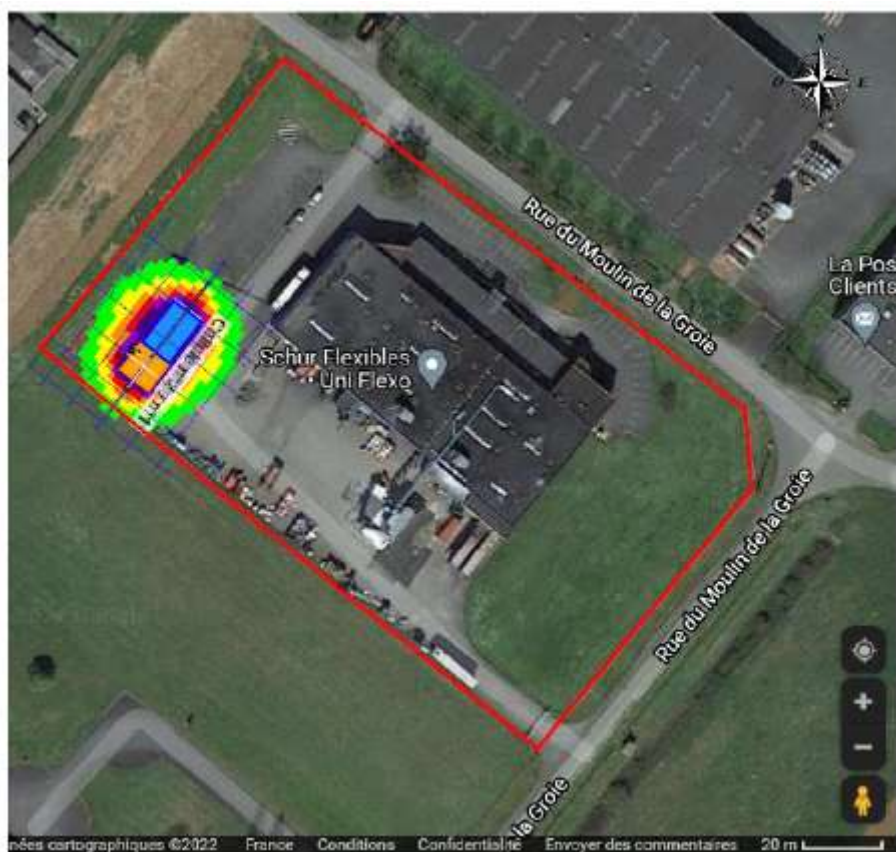
Incendie généralisé local coloriste + stockage des solvants (PhD6, effets thermiques), sans correction du mauvais report;
