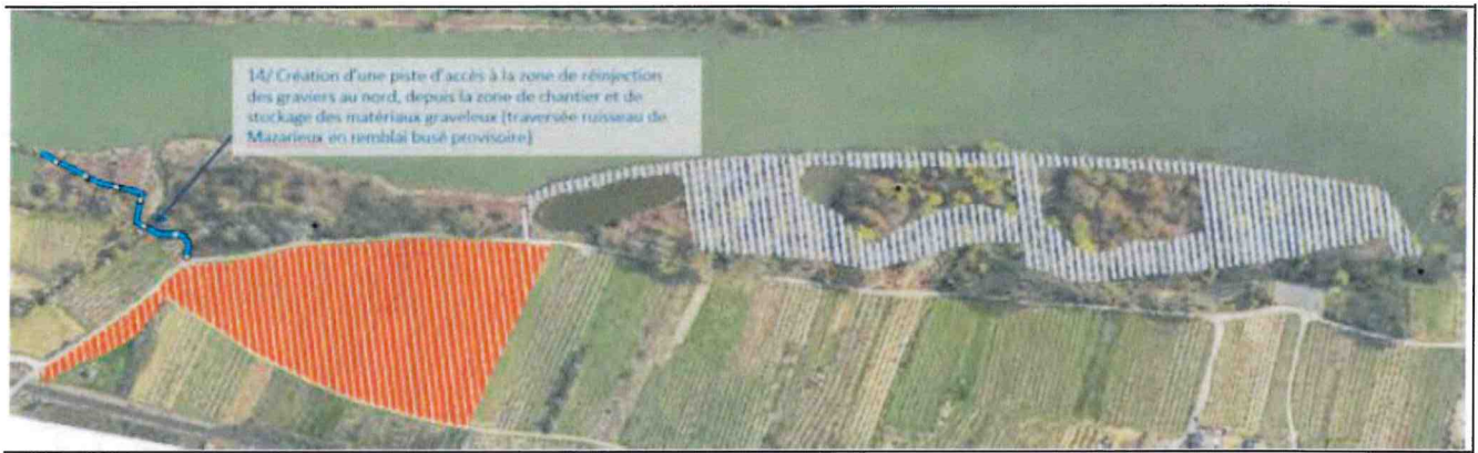
Phase 7 – Fin de saison 2 : Remise au Rhône des matériaux graveleux sous forme d'un merlon submersible substituant à terme une ancienne digue longitudinale submersible à démanteler
